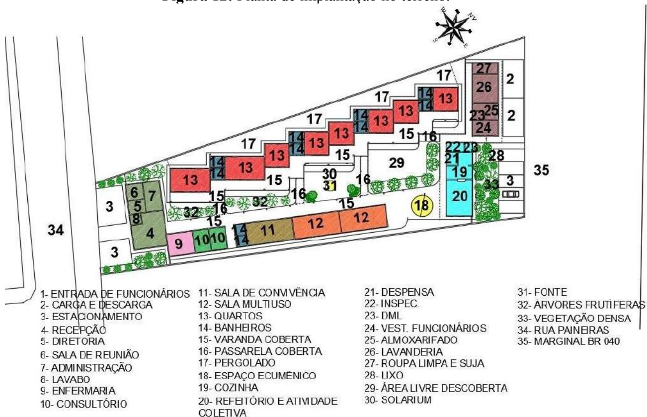
Figura 12: Planta de implantação no terreno.
